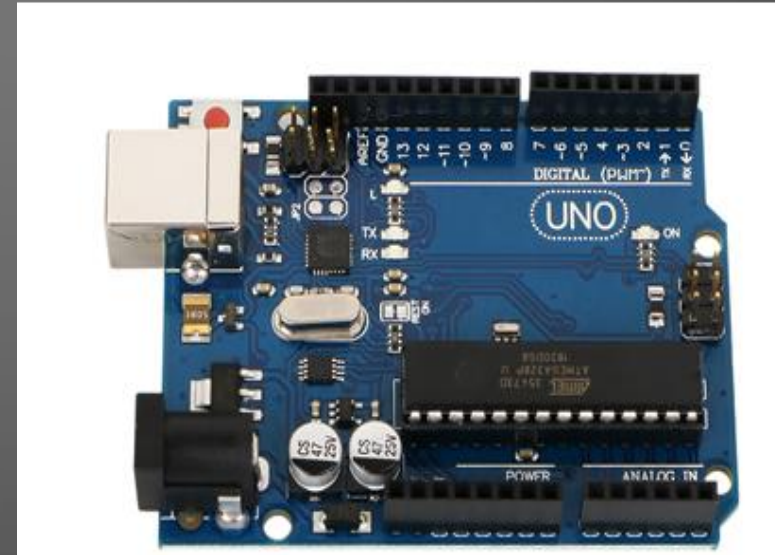
Arduino UNO Atmel (Microchip) ATMega328p microcontroller
